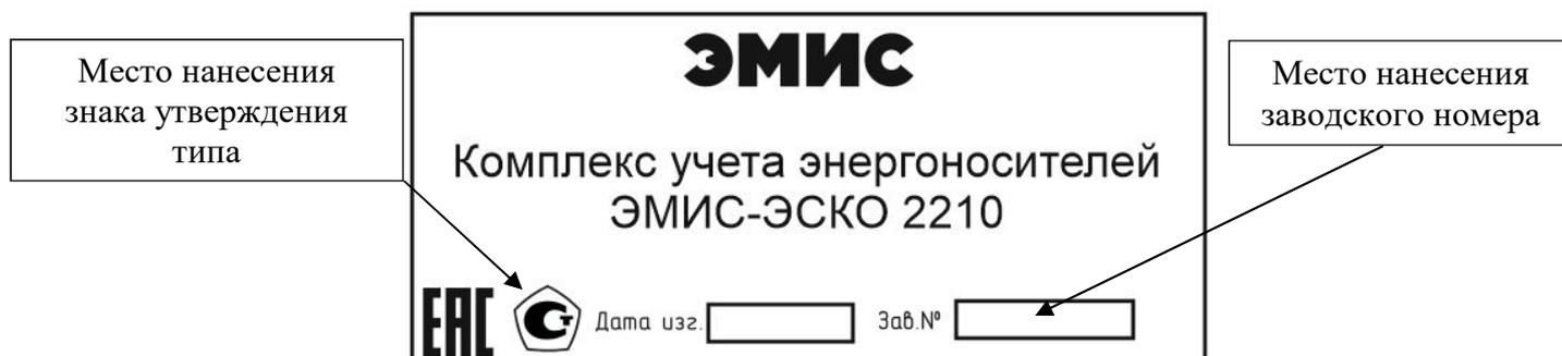
Рисунок 2 – Образец наклейки и места расположения заводского номера и знака утверждения типа комплекса
