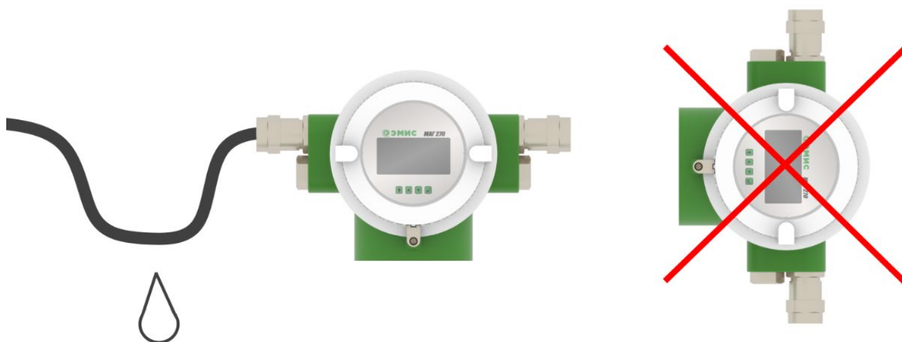
Рисунок 2.6 - Рекомендации по расположению кабелей и кабельных вводов
