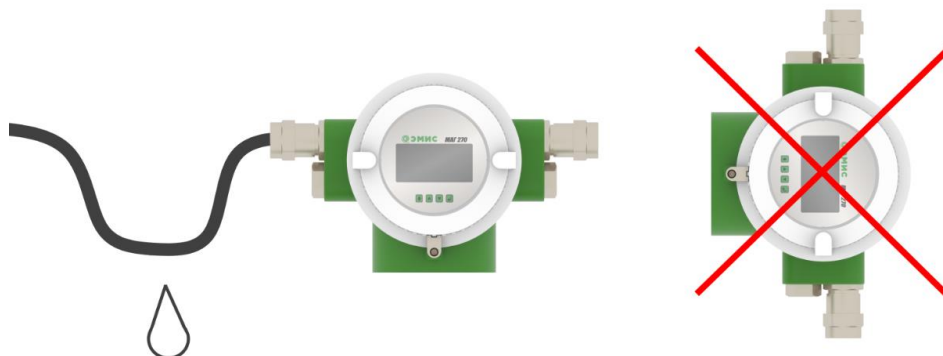
Рисунок 2.8 - Рекомендации по расположению кабелей и кабельных вводов
