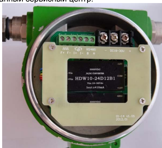
Рисунок 8.1 – Снять плату шильда
