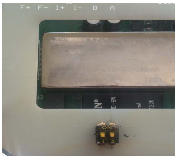
Рисунок 6.6 – Дополнительный блок переключателей (положение OFF)
