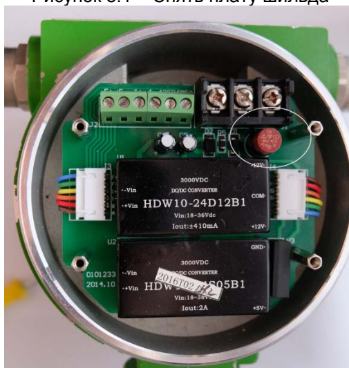
Рисунок 8.2 – Вытащить и проверить указанный предохранитель
