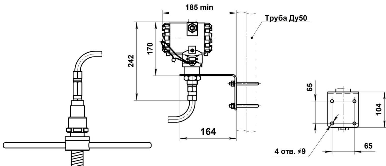
Рисунок Б.4 – Размеры погружного преобразователя дистанционного исполнения
