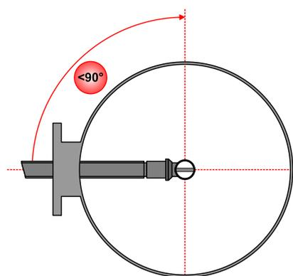
Датчик погружного преобразователя может быть установлен в центре трубопровода (**R**) или в точке средних скоростей потока (**H=0,242R**). Возможное положение датчика показано на **рис. 2.3**
