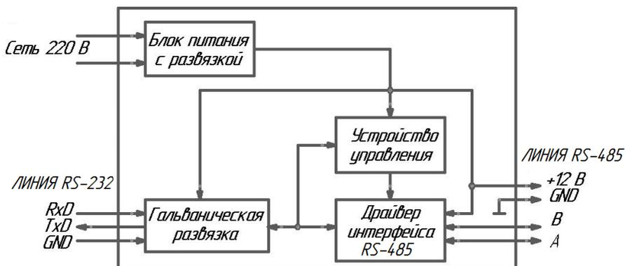
Рисунок 2 — Функциональная схема конвертера ЭМИС-СИСТЕМА 750 - RS-485 - RS-232
