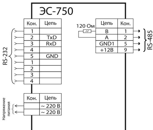
Рисунок 4 — Схема подключения конвертера ЭМИС-СИСТЕМА 750 - RS-485 - RS-232
