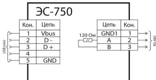
Рисунок 3 — Схема подключения конвертера ЭМИС-СИСТЕМА 750 - RS-485 - USB
