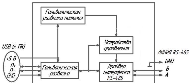
Рисунок 1 — Функциональная схема конвертера ЭМИС-СИСТЕМА 750 - RS-485 - USB
