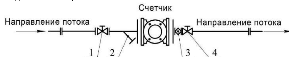
Рисунок 2.8 – Установка счетчика без перепускной линии
