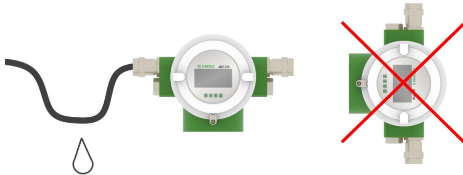
Рисунок 2.7 – Рекомендации по расположению кабелей и кабельных вводов
