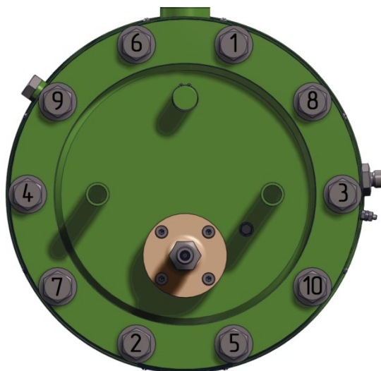
Рисунок 2.5 – Последовательность затяжки болтов фланца
